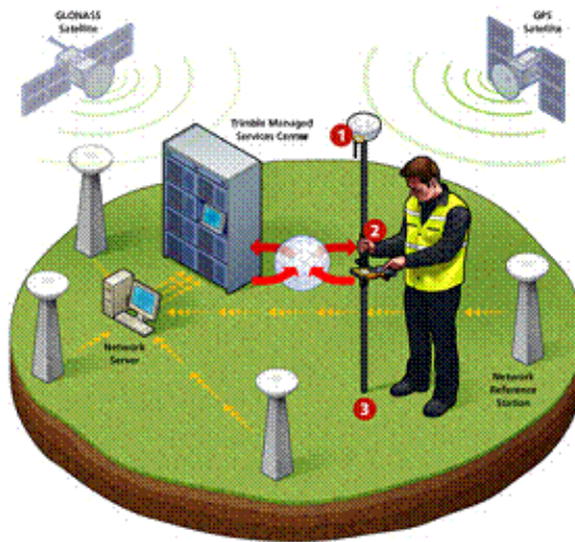
Şekil 6. Ağ prensibi ile RTK ölçme yöntemi (CORS sistemi)
